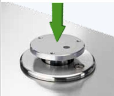
La célula de carga dispone de protección mecánica contra sobrecarga estática vertical de entre 25 y 50 veces la capacidad de pesaje. Esto protege el módulo de pesaje en caso de fallo en los dispositivos de manejo o errores durante la instalación.
