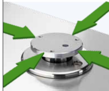
La célula de carga dispone de protección mecánica contra fuerzas laterales como las que se producen durante la carga y descarga automática del plato de pesaje o en caso de fallo del equipo de manejo.
