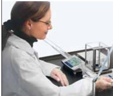
Los módulos de pesaje WXT compactos con carcasa revestida en polvo son ideales para procesos de pesaje manual cuando el espacio escasea. La accesibilidad 360° maximiza la flexibilidad cuando importa tanto la disposición como el funcionamiento.
