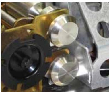
En cualquier momento puede comprobarse la funcionalidad, linealidad y precisión con las dos pesas de calibración integradas. Para calibrar no es necesario retirar los adaptadores de la parte superior del plato de pesaje si suman menos del 25% de la carga total.
