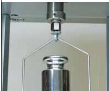
Un adaptador opcional permite pesar cargas suspendidas por debajo del módulo de pesaje. La protección contra sobrecarga se mantiene en todas las direcciones.
