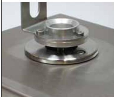
El plato de pesaje tiene tres orificios para fijar los adaptadores personalizados de sujeción de tubos o viales. Un adaptador puede pesar 1/3 de la carga total sin limitar la capacidad de pesaje. El plato puede separarse del módulo de pesaje sin utilizar herramientas.
