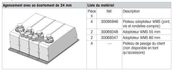
Des configurations de quatre modules de pesage WMS avec une distance de point de pesage de 24 mm jusqu'à 48 mm avec huit modules de pesage sont possibles. Les bras flexibles et de rotation à 360° permettent une grande variété de configurations. Aucune protection supplémentaire contre les surcharges n'est intégrée aux bras d'extension WMS. Il est recommandé de constituer une protection contre les surcharges externe afin de protéger le module de pesage WMS autant que possible.
