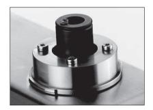
Placez le cache et fixez-le avec les 4 vis M3 x 20 (couple maximal : 0,8 Nm).
