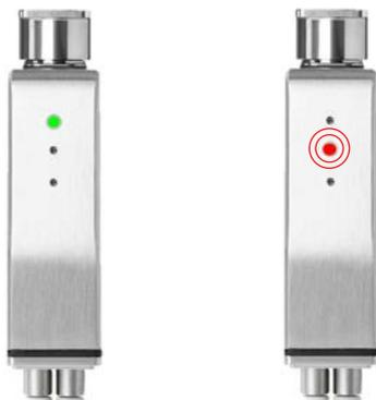
La diode LED d'état du module de pesage indique que l'installation et la communication fonctionnent.
