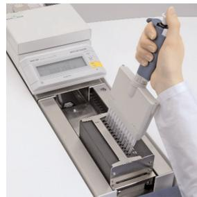
**Pipette multicanale** vengono tarate facilmente, rapidamente ed in modo economico grazie al meccanismo di trasporto fornito in dotazione.
