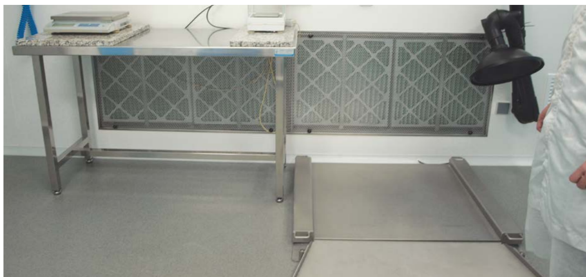
梅特勒-托利多称重系统包含平台秤和台秤以及称重终端。
