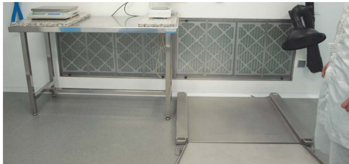
Zum Wägesystem von METTLER TOLEDO gehören Boden- und Tischwaagen sowie ein Wägeterminal.
