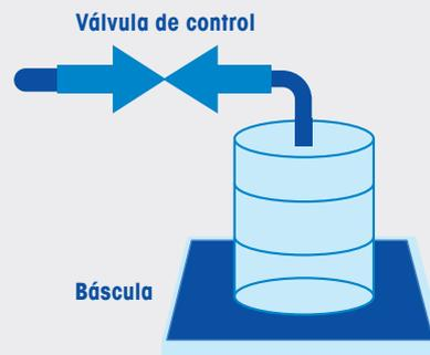
La uniformidad con la que una válvula abre y cierra un alimentador o con la que un transportador se inicia y se detiene va de la mano de la exactitud. Esta uniformidad le ayuda a asegurar unos resultados excelentes y hace que su algoritmo de control sea más robusto.
