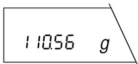
Si se sobrepasa el campo fino en el indicador, éste cambia automáticamente a la precisión de indicación menor.
