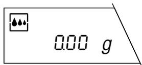
Pulse brevemente la tecla «
