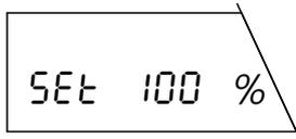
Su balanza necesita un peso de referencia que corresponda al 100%. Pulse la tecla «F» y téngala pulsada hasta que se le pida cargar el peso de referencia. Cargue ahora el peso de referencia.
