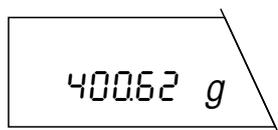
La balanza trabaja con **precisión de indicación y velocidad normales**.
