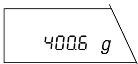
... la balanza trabaja con **menor precisión de indicación** (un decimal menos), pero muestra el resultado con bastante **mayor rapidez**. Con otra pulsación corta de la tecla «**1/10d**» puede Vd. volver a la precisión de indicación normal.
