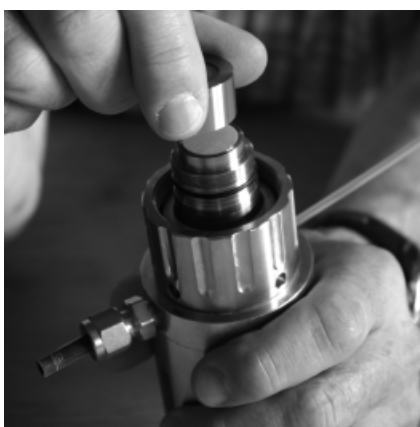
Fig. 5 : Mise en place du nouveau MembraCap au-dessus de la sonde
