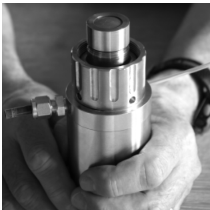
Abb. 1: Halten Sie den Sensor bei Wartungsarbeiten wie Austausch der MembraCap stets mit dem Kopf nach unten.
