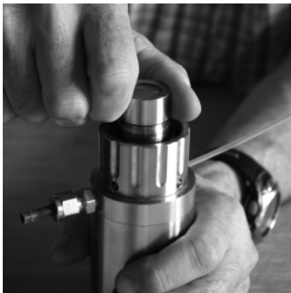
Abb. 4: MembraCap entgegen dem Uhrzeigersinn abschrauben
